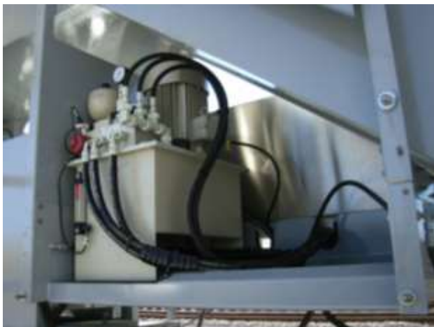
Abbildung 4: Standardaggregat der Firma Tries eingebaut in einen Portalkran
